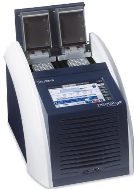
Viele Anwender? Verschiedene Experimente? Wenig Platz? Probenaufkommen zu gering für einen 96 Well Cycler? Dann ist das peqSTAR 2X Doppelblocksystem mit zwei unabhängig bedienbaren 48 Well Blöcken in einem Gerät die optimale Lösung – für maximale Flexibilität bei minimalem Platzbedarf!
